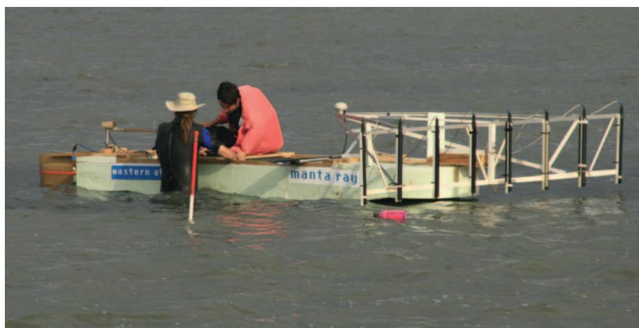
3 Geomagnetische Messungen im August 2009 über der Untiefe „Burg“ (Stelle der mutmaßlichen Kranenburg). Kunststoffboot mit dem Array aus acht Geomagnetik-Messsonden am Bug und einer Georadarantenne am Heck.
