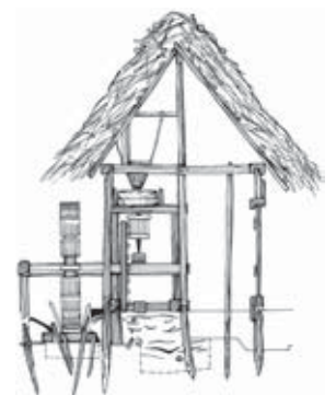
Zeichnerische Rekonstruktion einer merowingischen Wassermühle (Ende 7. Jh.) aus Dasing bei Augsburg (Bayern).
