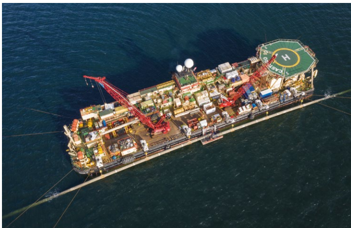
Abb. 32: Das Pipeline-verlegungsfahrzeug Castoro 10 im Greifswalder Bodden. Die Ankerkabel, mit deren Hilfe das Fahrzeug bewegt wird, sind deutlich erkennbar.
