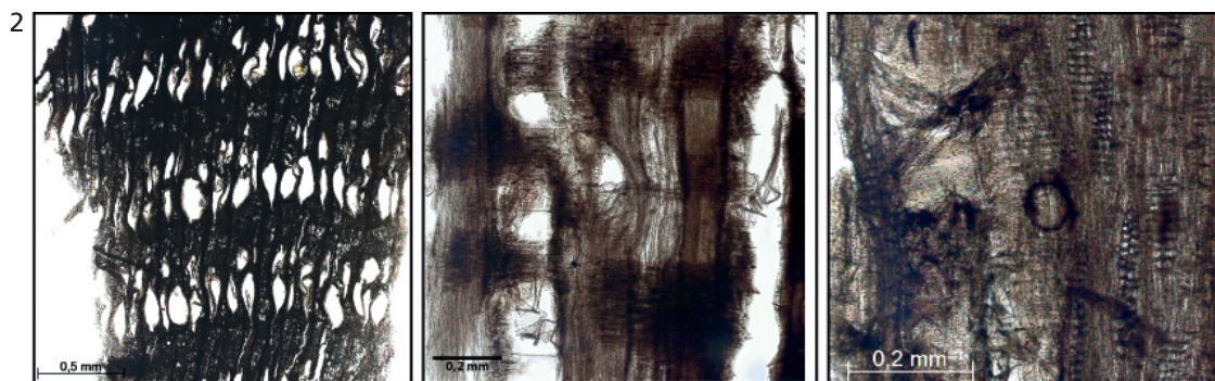
Fraxinus excelsior L.: Quer-, Tangential- und Radialschnitt
