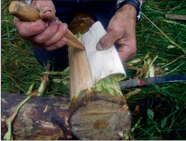
Abb. 48 Entfernen der inneren Rinde von einem Stamm. – (Foto J. Kämäräinen).
